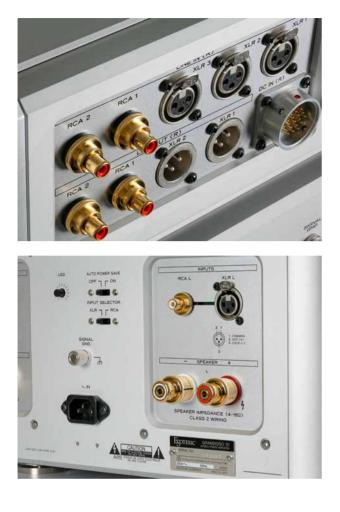
DETAIL OF C1, AND THE REAR SIDE OF THE S1 HAS EVERY-THING A STE-REO POWER AMP NEEDS— PLUS A CON-TROL KNOB TO REGULATE THE INTENSI-TY OF THE BLUE LIGHT.
